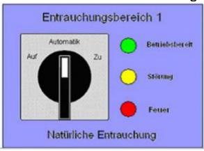
Steuerungsschalter mit 3 Funktionen Auf / Automatik / Zu
