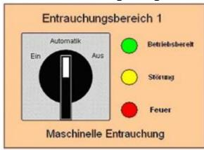
Steuerungsschalter mit 3 Funktionen Ein / Automatik / Aus
